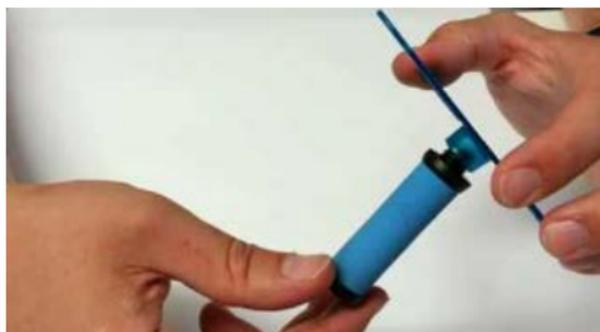
En ne touchant que la partie plastique du cylindre de couleur (B), et le tube en verre (C), faire glisser la cartouche de mesure (D) dans le tube en verre (C).
