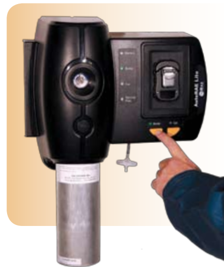
Test fonctionnel du ToxiRAE 3 avec la station d'étalonnage et de tests AutoRAE Lite
